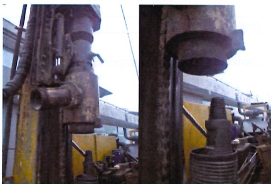
Tête de rotation équipée avec le système de récupération des cuttings
